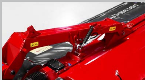
Én sylinder låser maskinens senteroppheng når maskinen løftes, slik at den går klar av ferdigslått gras.
