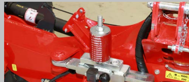
CSS kollisjonssikring. Ved en eventuell påkjørsel vil maskinen i samme bevegelse gå opp og bakover for å unngåe hindringen.
