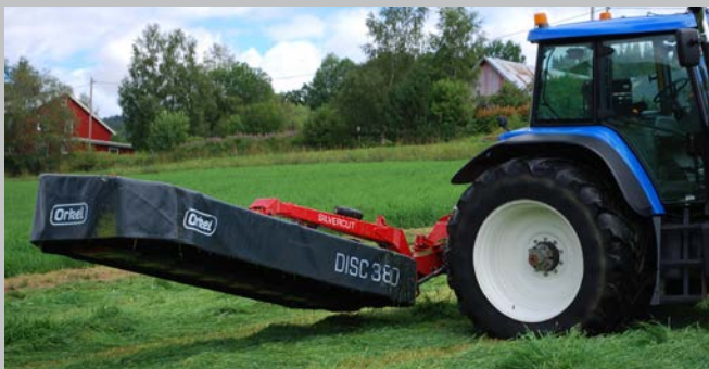
Én sylinder låser maskinens senteroppheng når maskinen løftes, slik at den går klar av ferdigslått gras.
