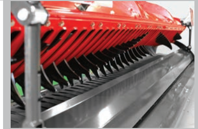
Pick-up'en i kombinasjon med en hydraulisk materotor gir effektiv og skånsom innmating.
