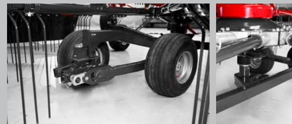
Patentert pendlende tandemaksel.
